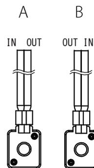
必ずモータ軸が水平になるよう取付けください。
