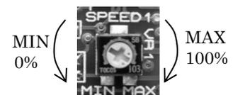
(※1) スピードコントロール機能を他の機能に切り替えてスピードコントロールする場合は(例えば、VR1を使用した動作の後、PWM入力で作動させる場合等)、一度、電源をOFF(5秒以上)してから、再度、ONさせてください。
