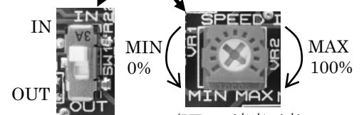
(SW1: 外部・内部制御切替スイッチ) (VR1: 速度可変ボリューム)
