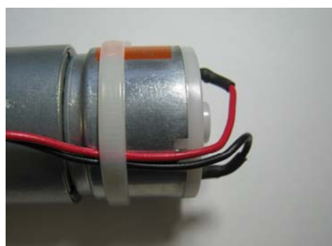
モータボディにリード線を結束固定
