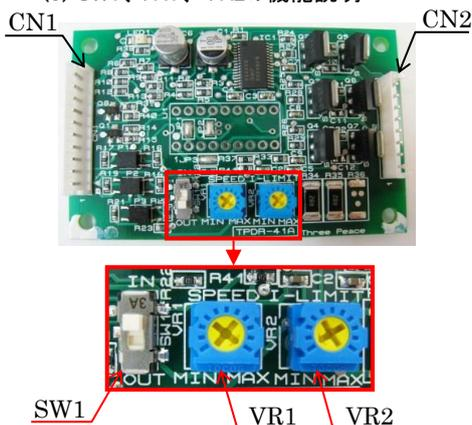
SW1: 内部制御と外部制御を切り替える為のスイッチです。
