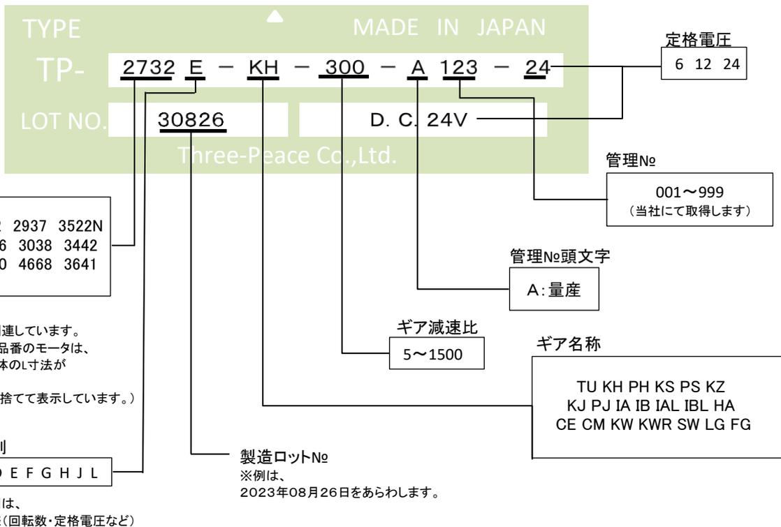
※モータ品番は、モータの外形図と関連しています。例えば、2732という品番のモータは、外径がφ27mm、本体のL寸法が32mmとなります。(小数点以下は切り捨てて表示しています。)
