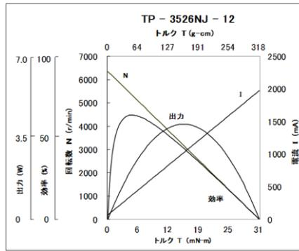
MOTOR  $\phi 35.4\text{mm}$  RoHS 対応品 ドライバ TPDR-68A 絶縁階級 E種 極数: 2 スロット数: 3
