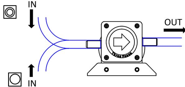
◆ 水口が縦にある場合は吸入口は下にして下さい。吸入口を上置かれると気泡が液送方向とは逆に流れてしまうため流量の妨げとなります。
