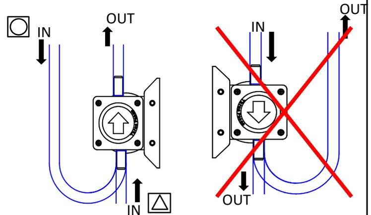
◆ ポンプは水平方向に設置するのを推奨します。
